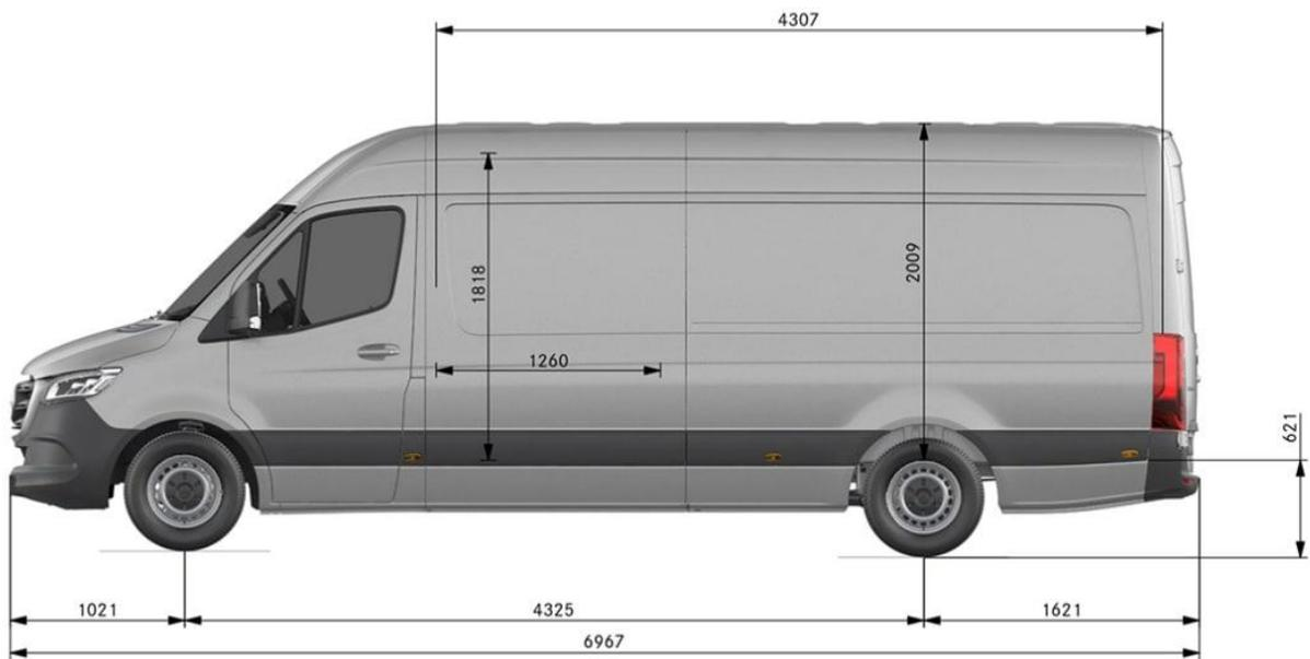
**Удлиненный с высокой крышей, 3500 кг, задний привод**
